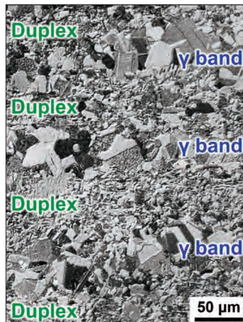
図3 EB-PBFで造形した48-2-2合金に形成される特異なバンド状組織 (Online version in color.)
