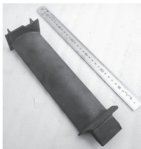
図6 EB-PBFで造形した48-2-2合金の低圧タービン翼
